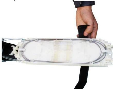
(7) Sellado del cable en la base: Limpie cuidadosamente el cable y el tubo de acceso en una longitud de 10 cm.
