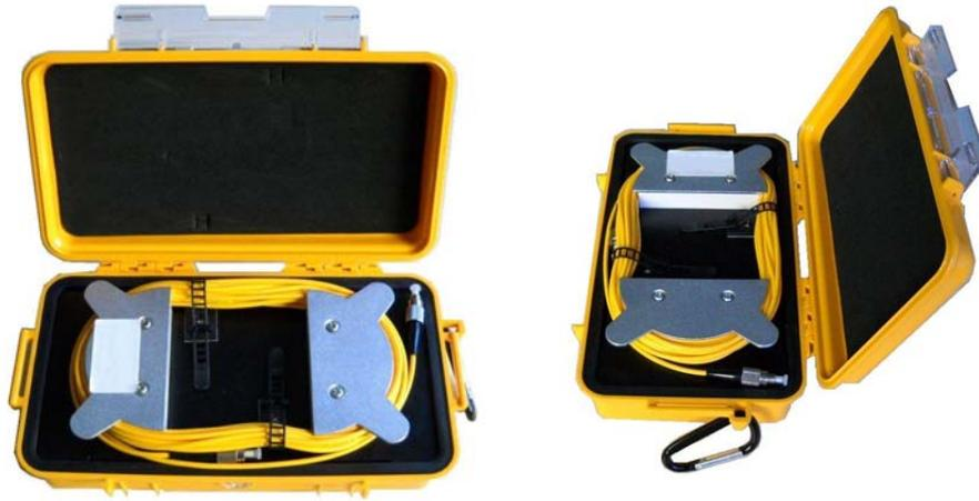
Las bobinas de lanzamiento son utilizadas, al realizar medidas con OTDRs (Reflectómetros ópticos en el dominio del tiempo), para eliminar los efectos de las zonas muertas.
