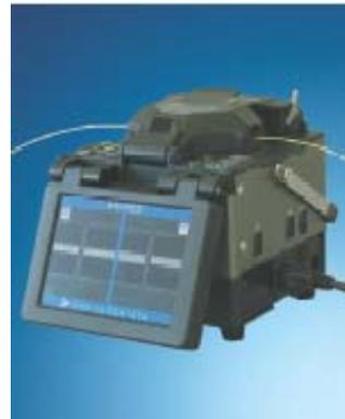
Los **empalmes por fusión** , consistentes básicamente en el corte, enfrentamiento , fusión mediante arco eléctrico y reconstrucción posterior de los extremos de las fibras del cable y los rabillos; proporcionan uniones de excelente calidad y muy baja atenuación ( del orden de 0,01 dB), precisando de determinadas herramientas ( kits de preparación, corte y fusión de la fibra) de precio relativamente elevado, pero alto rendimiento.
