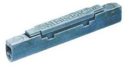
El empalme mecánico Fibrlok consiste básicamente en un cuerpo de material plástico de alta resistencia, en cuyo interior se encuentra una pieza metálica que garantiza un perfecto enfrentamiento y fijación de la fibra óptica. El empalme universal puede ser utilizado para fibra óptica monomodo o multimodo, con revestimiento de 125 um y recubrimiento de 900 um ó 250 um
