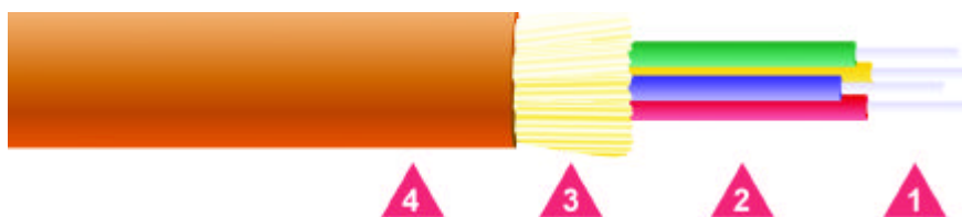
Fig.3: Cable óptico CDI de interior (1):F.óptica (2):recubrimiento ajustado (3): refuerzo de aramida. (4) Cubierta exterior LSZH
