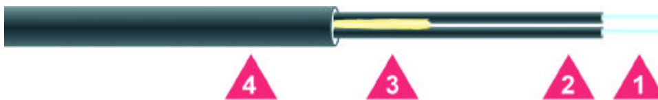
Fig.5: Cable FOP-R Duplex: (1):Fibra plástica (2) protección individual (3) refuerzo de aramida (4) Cubierta exterior FRLS.
