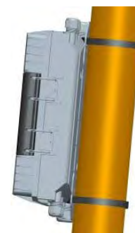
Caja con amarre a poste
