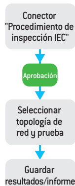
Ilustración 3-21. Proceso de caracterización iOLM
