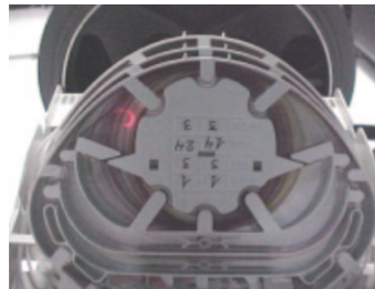
Ilustración 2-7. Macrocurvatura detectada con VFL
