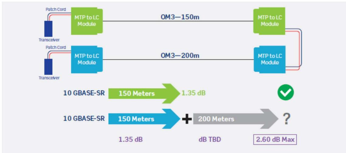
Figura 2: Efectos de la inclusión de componentes a un canal.
