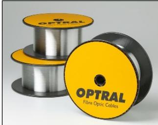
Fibras ópticas multimodo de 62,5/125 micras de índice gradual. Estas fibras están diseñadas para ser utilizadas a 850 nm y 1300 nm. Adecuadas para su uso en aplicaciones de cableado como las Redes de Área Local (LAN) con video, datos y voz, utilizando LED, VCSEL o Laser Fabry Perot.
