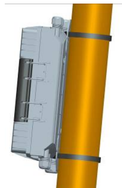
Figura 6: Fijación a poste
