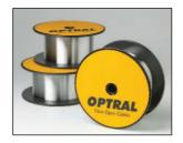
Fibra óptica multimodo de salto de índice PCF 200/230 micras. Esta fibra está diseñada para ser utilizada en las longitudes de onda de 650 nm y 850 nm. Adecuada para enlaces de vídeo y datos en cortas distancias, sistemas sensores (médicos e industriales) y en iluminación.
