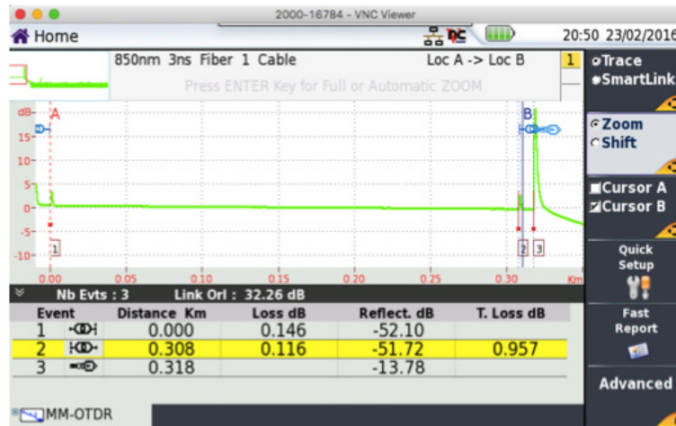
Figure 3. Actual OTDR trace display
