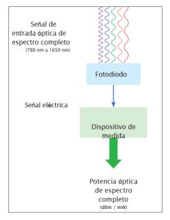
Los medidores de potencia así construidos medirán la energía fotónica de todas y cada una de las longitudes de onda de la luz dentro del rango del fotodiodo, y de ello resultará una sola medición de potencia proporcional a la suma de todos los fotones de todas las longitudes de onda por unidad de tiempo. (Véase la figura 1).
