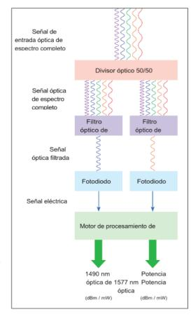
Los medidores de potencia PON construidos como tales pueden medir instantánea y simultáneamente la potencia óptica para las longitudes de onda filtradas de manera precisa e independiente, evitando las mediciones engañosas entregadas por los medidores de potencia de banda ancha en un entorno coexistente e identificando las longitudes de onda específicas asociadas con esas mediciones de potencia para PON coexistentes y paralelas.
