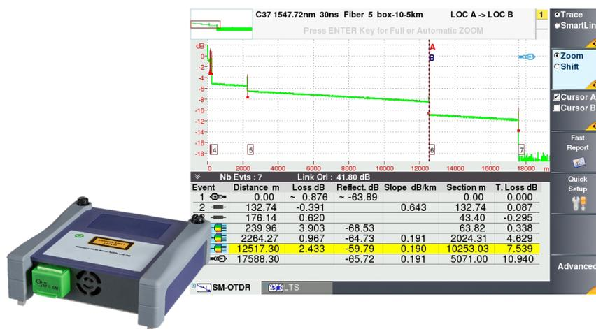
Figura 23. Módulo OTDR de DWDM
