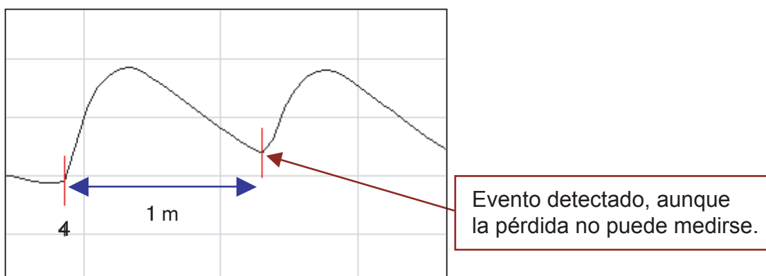
Figura 2. Serie FTB-7000D de EXFO con zona muerta de eventos de 1 m
