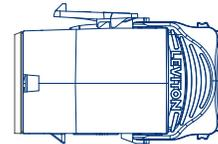
El cuerpo metálico sólido proporciona la durabilidad incomparable tanto en UTP como en conectores blindados y disipa el calor un 53% mejor que conectores plásticos para aplicaciones PoE.
