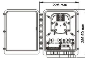
Una entrada circular para un pigtail de 6 y 4 de 2 mm
