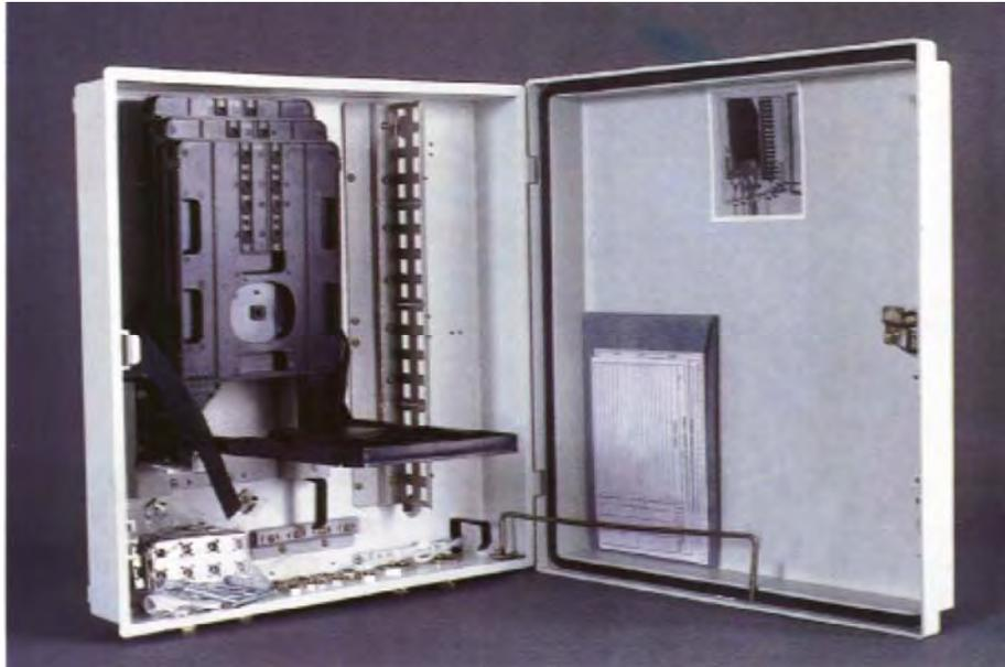
Este armario es empleado como elemento de terminación y repartición de las redes de fibra óptica en interior de edificios. Su configuración permite realizar cualquier segregación, según necesidades de las plantas, no excediendo el número de empalmes de 64, sólo en casos singulares hasta 128, y un máximo de 32 conectores.
