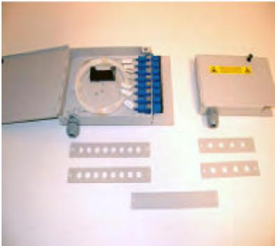
Las cajas terminales CF4/8, de reducido tamaño y fácil instalación, se utilizan para la terminación de cables de fibra óptica por conectorización directa o empalmes en el puesto de trabajo, tanto en sistemas informáticos como en instalaciones de control industrial en instalaciones de vídeo seguridad (vigilancia o control tráfico).
