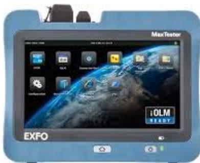
OTDR compacto, pantalla táctil 7", **concepto Tablet**, 2 Gb memoria interna, batería 12 horas.
